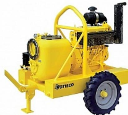
**ОСНОВНЫЕ ПРЕИМУЩЕСТВА:** Чугунная конструкция; Открытое рабочее колесо, позволяющее перекачивать воду с частицами диаметром до 76мм; Дизельный двигатель воздушного охлаждения D2011L04I с электростартером, объемом 3620 см<sup>3</sup> и максимальной мощностью 41 л.с. фирмы DEUTZ; Смазываемое механическое уплотнение. Компенсационная пластина с резиновым покрытием; Двухколесная тележка с топливным баком 420л, крюком для подъема помпы, регулируемым дышлом и откидной ножкой;
